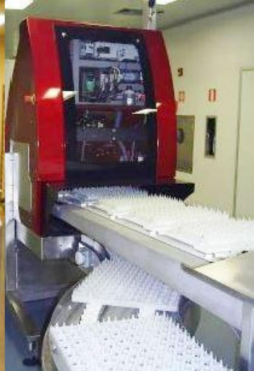
**Os ovos podem ser analisados automaticamente no ovoscópio automático, para verificar sua qualidade.**
