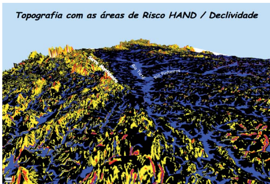
Figura 7. Aplicação do Modelo HAND para mapeamento das zonas de risco ambiental na região metropolitana de São Paulo, mostrando em azul as áreas sujeitas a inundações e enxurradas e em amarelo (risco alto) e vermelho (risco crítico) áreas sujeitas a deslizamentos e fluxos de massa. Em preto estão as áreas relativamente seguras para ocupação humana. Fonte: Nobre et al. (2010).
