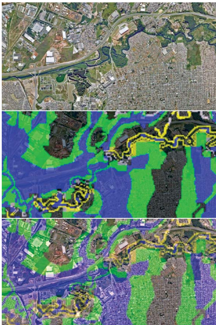
Figura 6. Mapa HAND de áreas sujeitas à inundaç o para a zona central da regi o metropolitana de S o Paulo, superposta   imagem de sat elite mostrando  reas urbanas suscet veis. a) imagem de sat elite do Jardim Pantanal, na regi o metropolitana de S o Paulo; b) Mapa HAND de  reas sujeitas   inundaç o para a mesma  rea; c) superposiç o do mapa de susceptibilidade com a imagem de sat elite mostrando detalhes de  reas suscet veis. Azul indica desn vel at  5 m e verde desn vel at  15 m em relaç o ao curso d' gua mais pr ximo. Fonte: Nobre et al. (2010).
